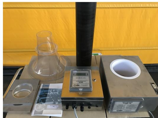
*Metal detector industriale con tunnel circolare di diametro di mm 200, per prodotti transitanti in tubazioni.*
